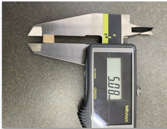
Figura 10: misurazione del cubo di calibrazione 3 con calibra-
