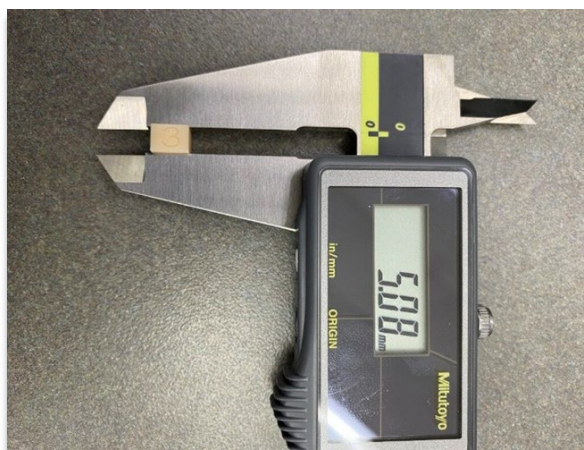
Figure 10 : Pieds à coulisse mesurant le cube d'étalonnage 2
