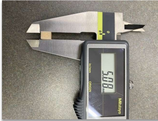
图10：用卡尺测量校准立方体3。
